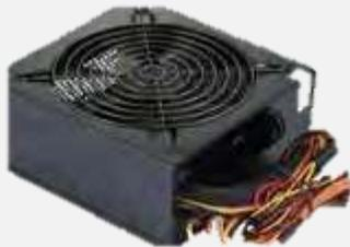
*Powersupply dan kabel-kabel untuk mengalirkan arus listrik ke komponen di dalam kotak CPU*
