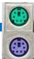
*Port PS/2. Port warna hijau (atas) digunakan untuk mouse dan warna ungu (bawah) untuk keyboard*
