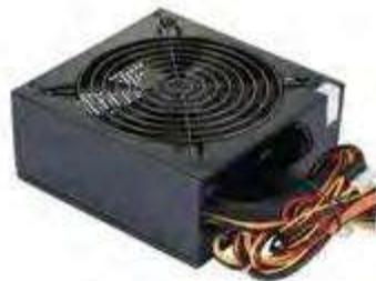
*Powersupply dan kabel-kabel untuk mengalirkan arus listrik ke komponen di dalam kotak CPU*
