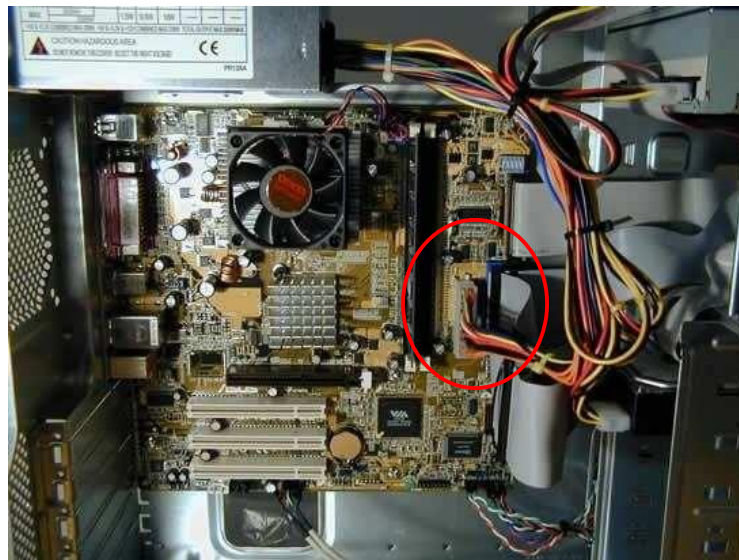
Gambar 20. Pemasangan Kabel pada Motherboard
