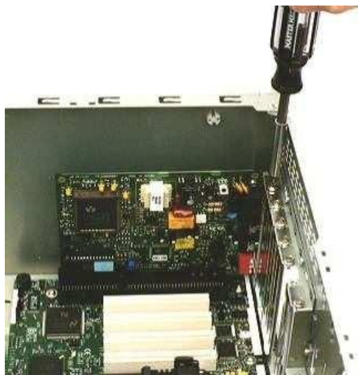
Gambar 27. Mengencangkan Epansion Card pada Casing
